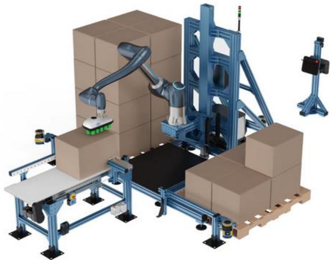
Figure 3 : Exemple de cellule de palettisation, avec robot collaboratif
